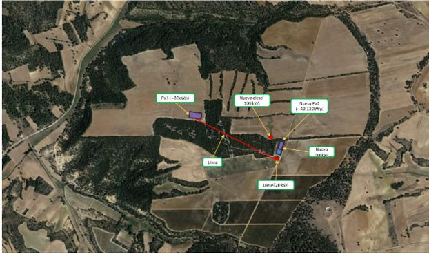
Figura 10. Mapa con elementos de la microrred eléctrica.
