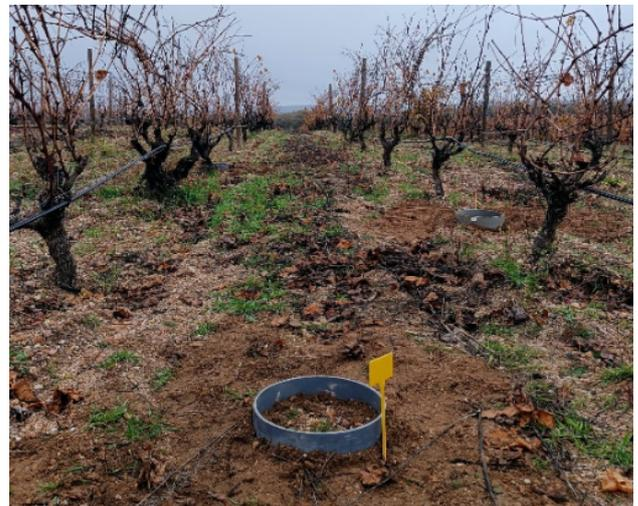
Figura 7. Cámara estática de recogida de gases.
