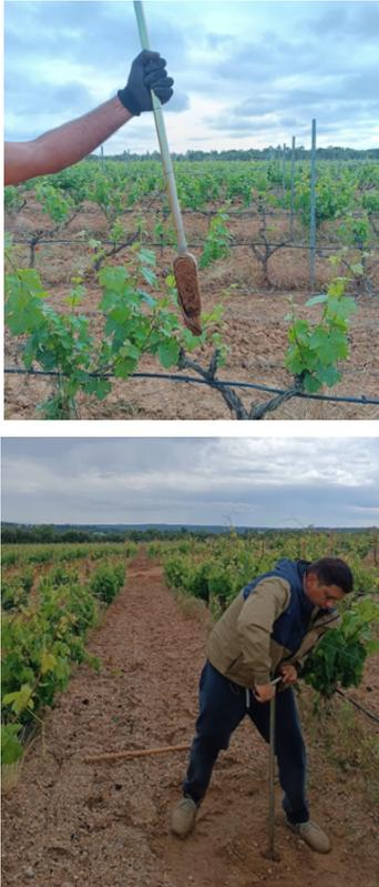
**Figura 8.** Toma de muestras de suelo con barrena en suelo.
