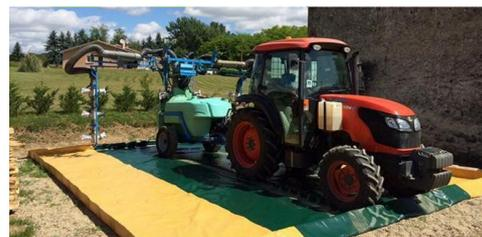
**Figure 9.** Un exemple d'aire souple de remplissage et de lavage des pulvérisateurs, photo [www.axe-environnement.eu](http://www.axe-environnement.eu)
