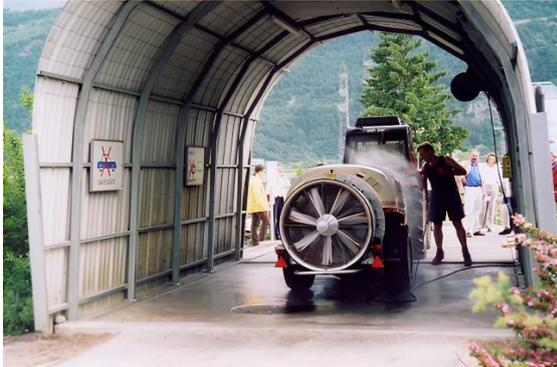
**Figure 23.** Première aire collective de lavage des pulvérisateurs développée en 1994 à Martigny dans le Valais en Suisse, photo J. Rochard.
