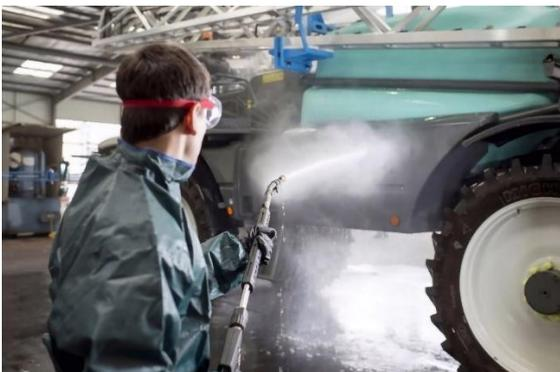
**Figure 15.** Lavage de l'extérieur du pulvérisateur avec un surpresseur, photo [www.bayer-agri.fr](http://www.bayer-agri.fr)
